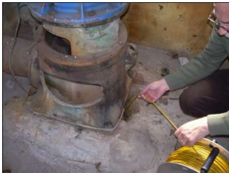
Figura 38 – Misura del livello di soggiacenza mediante freatimetro su un pozzo consortile
